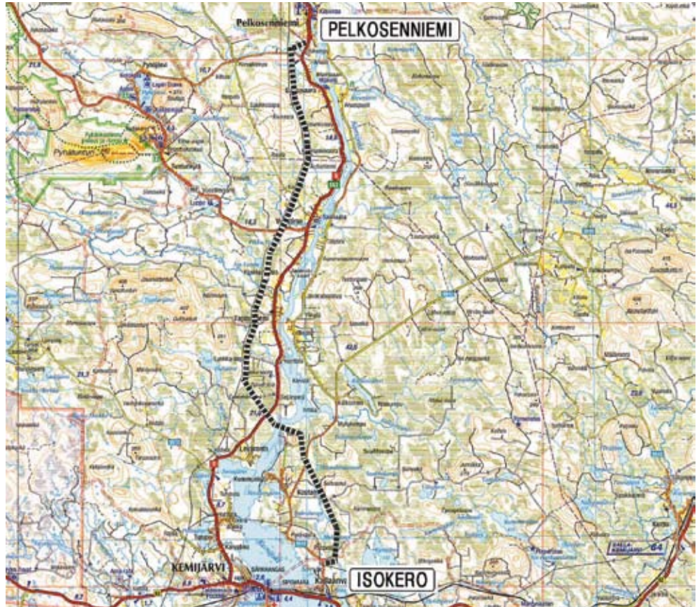
Voimajohdon pituus on noin 46 kilometriä. Kostamon itäpuolitse Varrion kylän pohjoispuolella Kemijoen ylittävä johto tulee turvetuotantoalueen länsipuolella kantaverkko-yhtiö Fingrid Oyj:n 220 kilovoltin johdon rinnalle.
